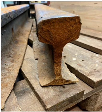
Abbildung 11-1: Korrosion am Schienenfuss
